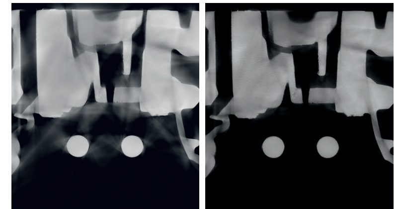
Bildqualität verbessern: Kegelstrahl-CT ohne (links) und mit ScatterFix 2.0 (rechts).
