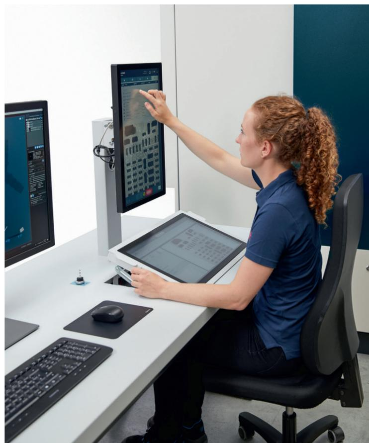
Für eine möglichst einfache Bedienung arbeiten beim FF20 CT System Software und Hardware Hand in Hand. Die übersichtliche Gestaltung des Bedienpults mit kippbaren Touchscreens ermöglicht es den Nutzern, sich voll auf ihre Prüfaufgabe zu konzentrieren. Für eine Bedienung im Sitzen oder Stehen lässt sich die Höhe des Tisches verstellen. Healthmonitor und Push-Nachrichten geben jederzeit Auskunft über den Systemstatus und den Prüffortschritt.
