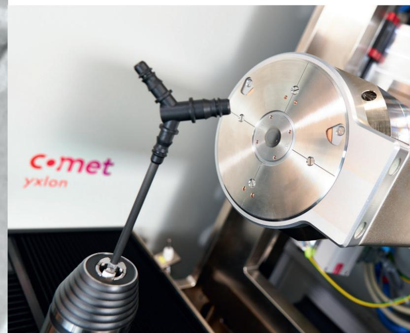
Die 190kV-Nanofokus-Transmissionsröhre des FF20 CT sorgt für hohe Detailsichtbarkeit.
